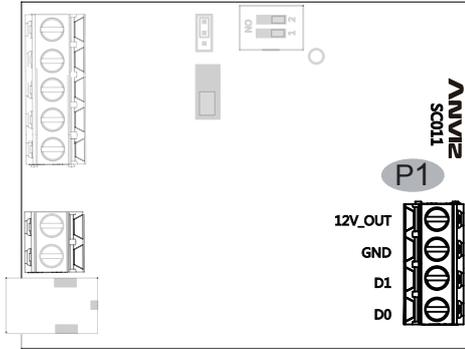
Соедините пожалуйста Anviz устройство с P1 интерфейсом на SC011.
